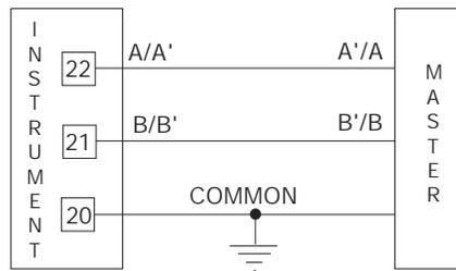
Fig. 17 - RS-485 WIRING
