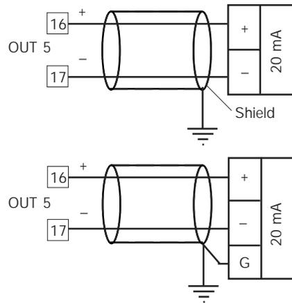
Fig. 16.A OUTPUT 5 WIRING
